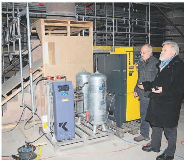
Zwei solcher Maschinen entziehen der Luft den Stickstoff und leiten ihn in das Folien-Zelt. Pfarrer Dr. Paul-Hermann Zellfelder und Architekt Jürgen Lemke betonen, dass für die Schädlingsbekämpfung eine umweltfreundliche und giftfreie Methode gewählt wurde. Foto: Hess
